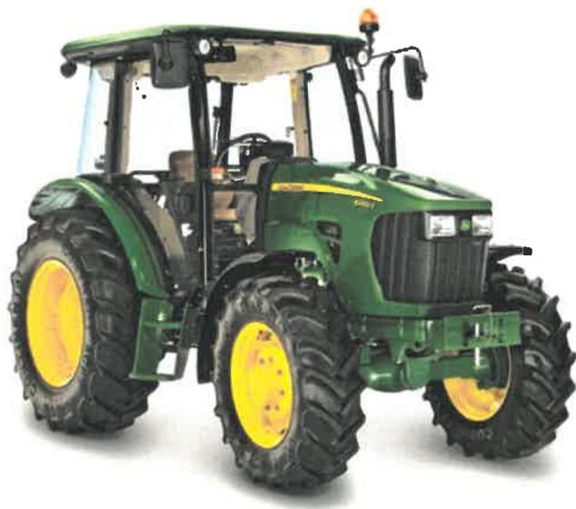
Tracteur fabriqué en France, puissance 75 CV, 4 roues motrices, cabine climatisée, siège à suspension, prise de force arrière 540 tr/min, relevage arrière, pneumatiques avant 320/85R24, arrière 420/85R30, empattement 2050mm, poids sans chargeur 3.3t, plaque SETRA, Triangle Triflash, gyrophare, équipé d'un chargeur Mailleux A104 à capacité de levage 1300 kg, et d'un godet de 2m de large
